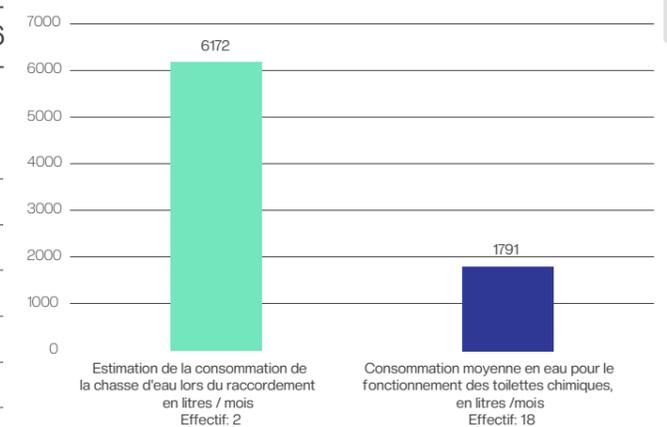
On constate que la consommation en eau des toilettes chimiques reste très réduite par rapport aux toilettes raccordées. Cependant, le ratio entre l'eau utilisée pour les toilettes chimiques et l'eau utilisée sur les chantiers (hors tamisage) est de 0,82, indiquant qu'il s'agit d'un poste de consommation non négligeable pour notre secteur d'activité.
